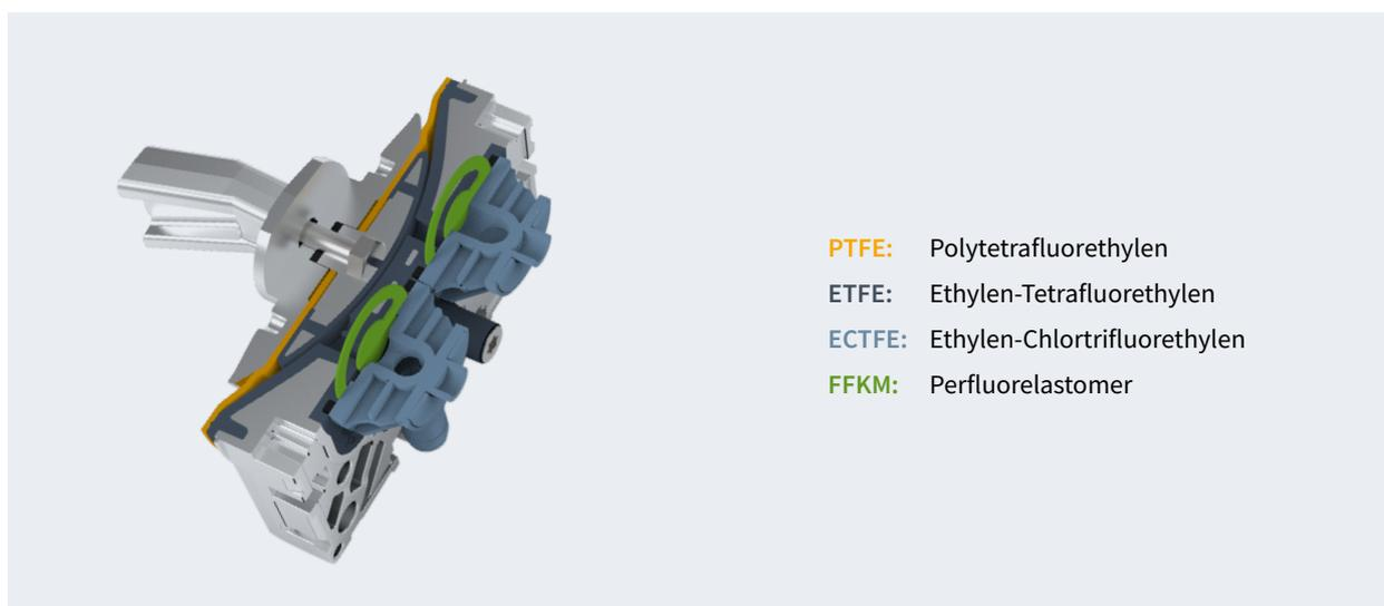
Abb. 5: Durchgängiger Einsatz von chemiebeständigen Kunststoffen bei allen medienberührten Materialien im Schöpfraum der Pumpe
